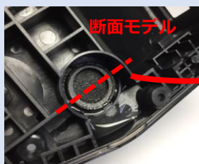
防水膜にかかる 水圧に負けて浸水
