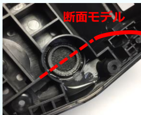
防水膜にかかる水圧に負けて浸水
