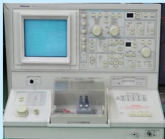
静特性設備 (カーブトレーサ)
